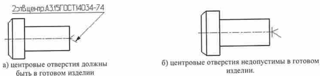
Рисунок 4. Указание на чертежах изделия сведений о центровых отверстиях
