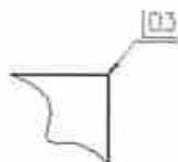
Рисунок 3. Пример указания на чертеже притупления кромки
