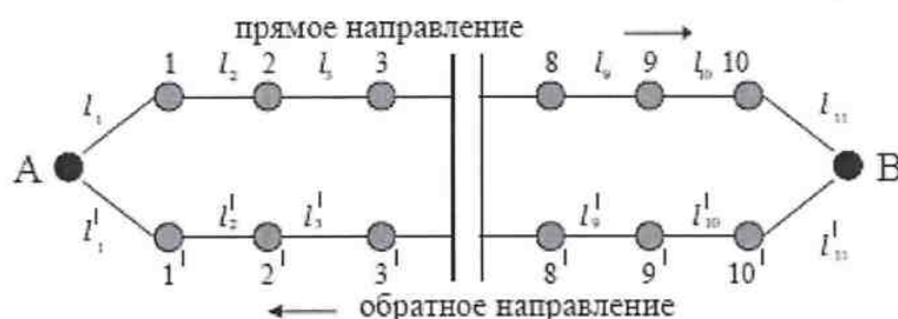
Рис. 1. Схема автобусного маршрута: А – начальный пункт; В – конечный пункт; 1, 2, 3, ..., 10, 1', 2', 3', ..., 10' – промежуточные остановочные пункты; l_1, l_2, l_3, \dots, l_{10}, l'_{10}, l'_{9}, l'_{8}, \dots, l'_1 – длины перегонов в прямом и обратном направлениях соответственно.
